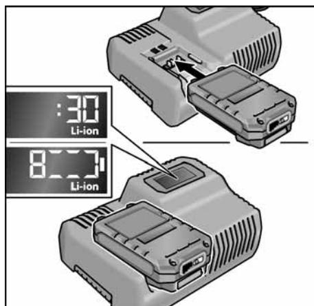
1. Conectar el enchufe del cargador. La iluminación de fondo de la pantalla se enciende en verde durante 2 segundos y vuelve a apagarse. En la pantalla se indica «OK».
