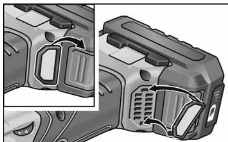
Retirez le filtre antipoussières et nettoyez-le avec de l'air comprimé sec.
